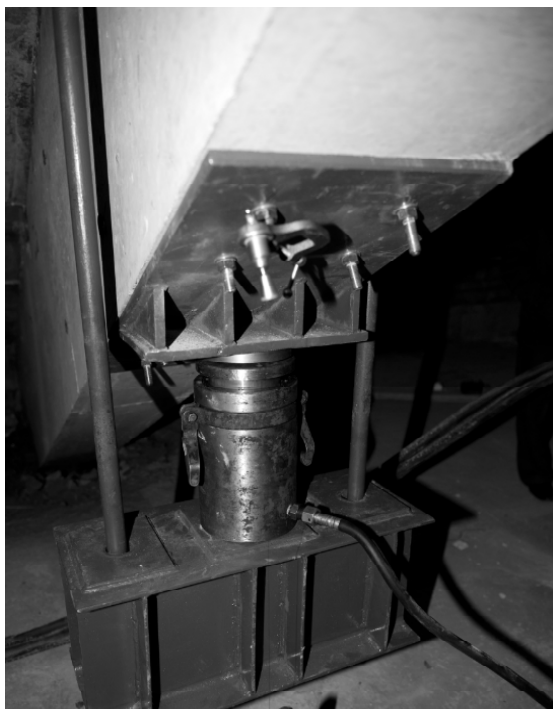
Рис. 4.2. Установка 100 тонного гидродомкрата для создания усилия P_2
