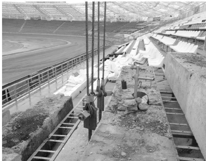
Рис. 4.4. Соединение тросов с тягами к домкрату для усилия P_2
