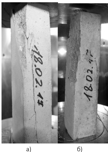
Рис. 2. Общий вид разрушенных образцов: а – армированных; б – без армирования
